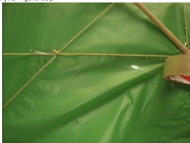
Figura 15. Pegado hilos a revestimiento.
