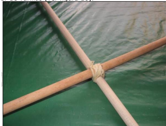
Figura 10. Amarre varillas de madera.
